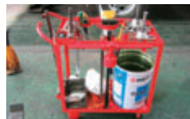
サービススタッフが製作した、作業性の良いホイール脱着ワゴン
