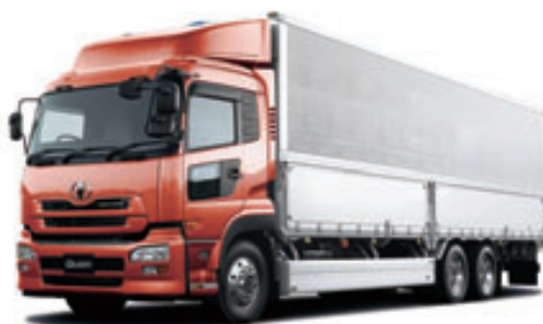
世界初の「尿素SCRシステム＝FLENDs」を搭載した大型トラック「クオン」
