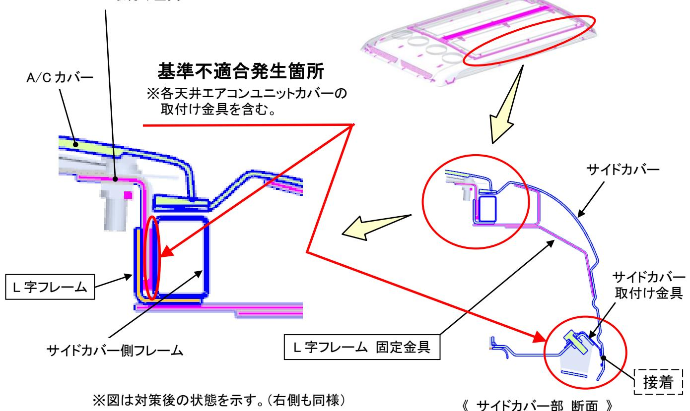
大・中型観光バスにおいて、天井エアコンユニットの樹脂製カバーを固定する金具類の防錆処置が不適切なため、当該金具類に錆が生じるものがある。そのため、そのままの状態で使用を続けると、当該金具類の接着力が錆の進行によって低下し、最悪の場合、強い横風等を受けるとカバーが持ち上がって固定部が破損し、天井エアコンユニットからカバーが脱落するおそれがある。
