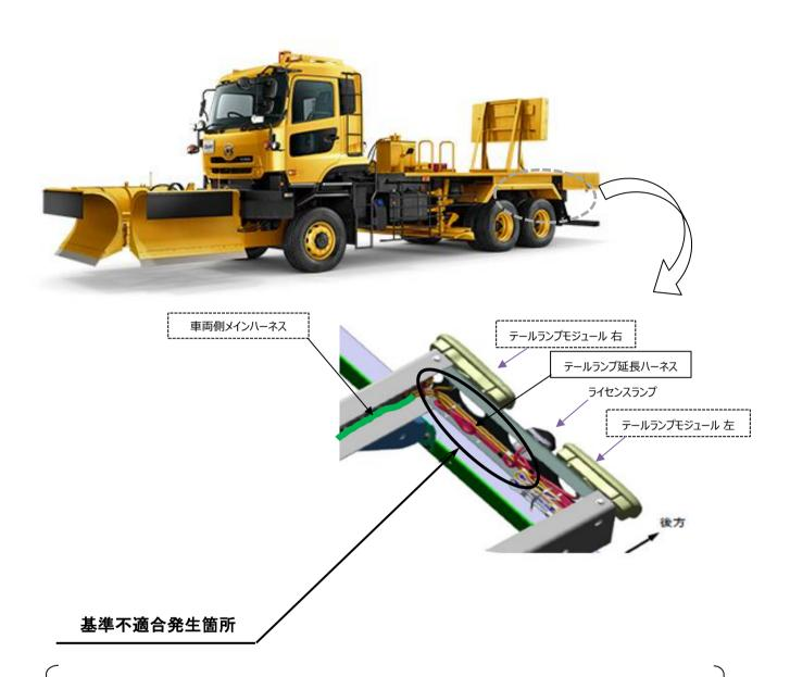
総輪駆動車(除雪車)のテールランプにおいて、後部改造に伴いテールランプに接続する ハーネスを延長した際に接合部の防水処理が不適切だったため、雨水または雪解け水等がハー ネス内に浸透しテールランプモジュールのコネクタ内部を腐食させることがあります。そのた め、接触不良または短絡によりテールランプ類が不点灯もしくは誤点灯するおそれがあります。
