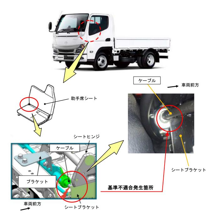
電動パーキングブレーキを搭載した四輪駆動の小型トラックにおいて、電動パーキングブレーキケーブルの配索が不適切なため、助手席のシートブラケットと当該ケーブルが干渉しているものがある。そのため、車両振動によって当該ケーブルの被覆部が摩耗し、最悪の場合、駐車中に当該ケーブルが切断して車両が勝手に動きだし衝突事故等を起こすおそれがある。
