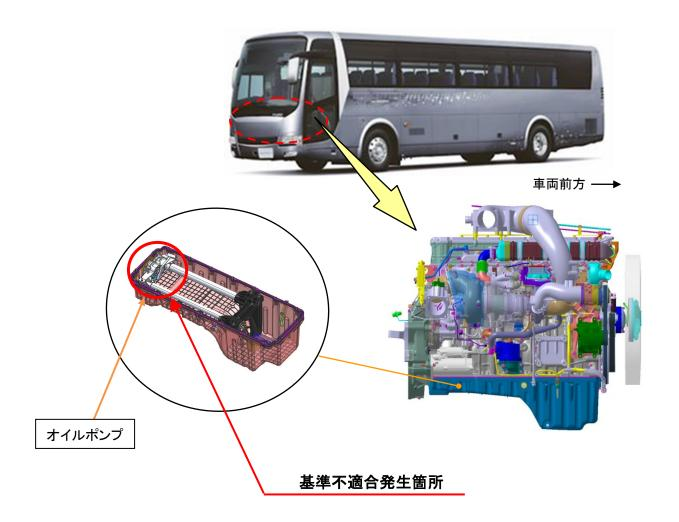
大型バスのエンジンにおいて、オイルポンプの製造のばらつきにより、ポンプのギヤシャフトが傾くことがある。そのため、ギヤの歯面が摩耗し、そのままの状態で使用を続けると、ギヤが破損してエンジンへの供給油圧が低下し、最悪の場合、エンジンが焼き付き路上故障や火災に至るおそれがある。
