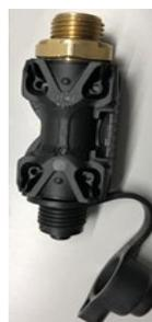
大型トラックのエアドライヤーにおいて、圧縮空気の圧力テスト用コネクタの材質が不適切なため、エアコンプレッサで作られた圧縮空気中に含まれる成分及び高圧力等によって、当該コネクタが腐食割れして圧縮空気漏れを起こすことがある。そのため、亀裂が進行すると圧縮空気の供給量が追い付かなくなるため、エア圧力低下の警告ランプ点灯及び警報が鳴り、最悪の場合、駐車ブレーキが解除できなくなり走行不能に至るおそれがある。
