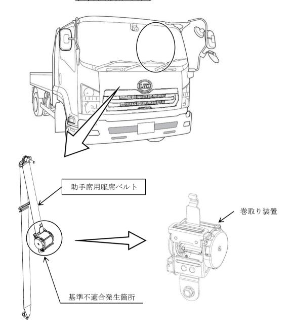
トラックの助手席用座席ベルトにおいて、組み付け設備の調整が不適切なため、巻取り装置ロック機構部のスプリングが屈曲して組み付けられたものがある。そのため、当該スプリングが構成部品と干渉し、座席ベルトが素早く引き出された際にロックしないおそれがある。
