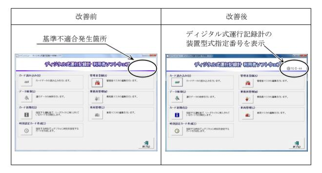
ディジタル式運行記録計の利用者ソフトウェアにおいて、画面表示プログラムが不適切なため、対応するディジタル式運行記録計の装置型式指定番号が電子ファイル保存装置の 画面に表示されず、道路運送車両法の保安基準(運行記録計の基準)に適合しない。
