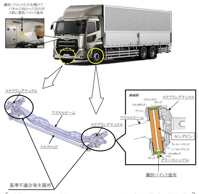
大型トラックのかじ取り装置において、アクスルビームとキングピンの嵌め合い寸法が不適切なため、過度な使用を繰り返すと、キングピンの保持力が低下しキングピンが降下するものがある。そのため、キングピンがステアリングナックル上部から分離してホイールアライメントが狂い、タイヤの偏摩耗及びハンドル操作に違和感が発生し、最悪の場合、直進安定性が損なわれるおそれがある。
