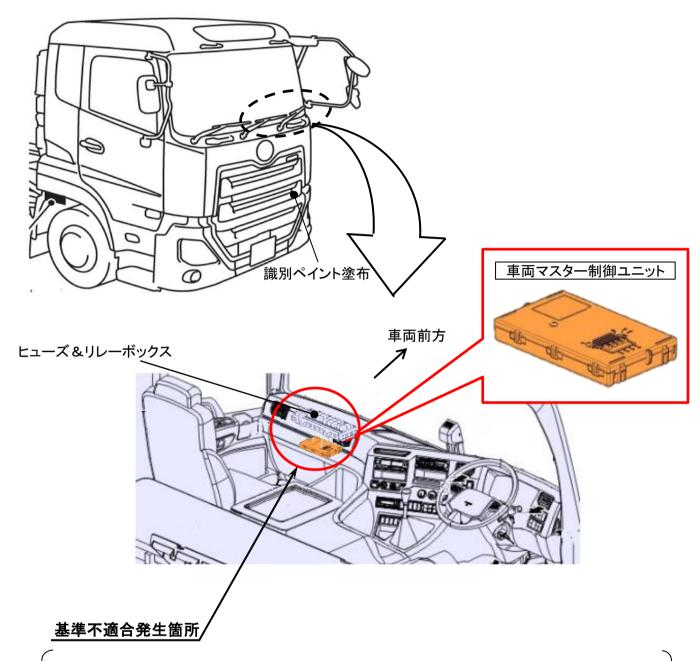
窓ふき器において、ワイパーの作動を制御する車両マスター制御ユニットのプログラムが不適切なため、間欠モードでワイパーが作動中、一時停止する瞬間にワイパースイッチを低速(Lo)モードに切り替えると、ワイパーリレーの接点部でアーク放電が発生することがある。そのため、ワイパーの電源回路に過電流が流れヒューズが切れて、ワイパーが不作動となり必要な視野を確保できなくなるおそれがある。
