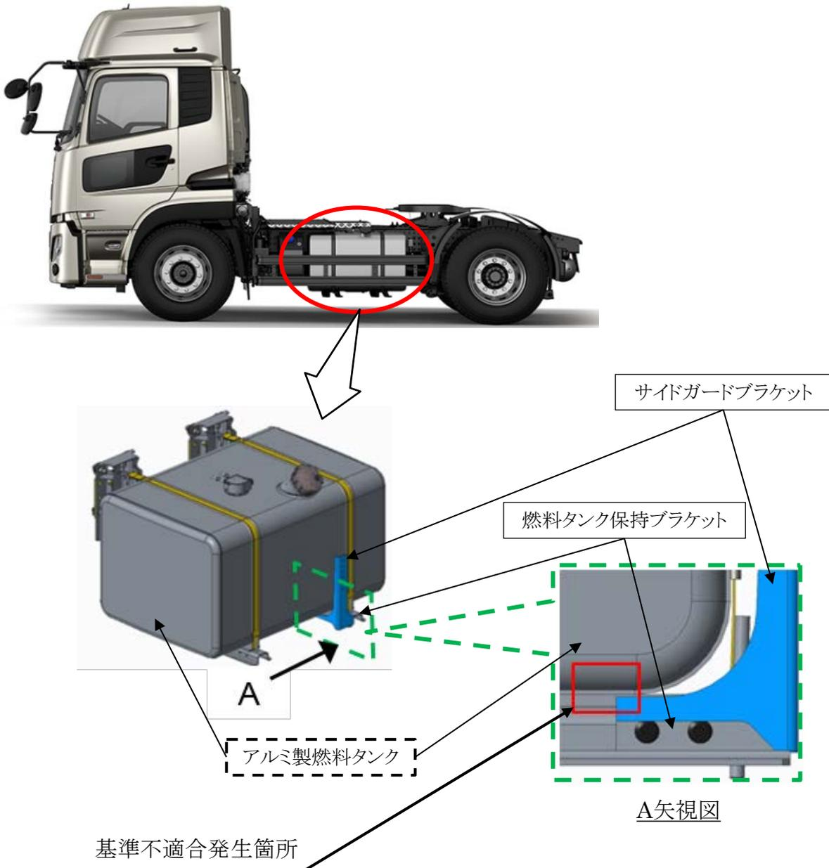
大型トラックの燃料装置において、燃料タンク保持ブラケットの成型加工が不適切なため、当該ブラケットに固定しているサイドガードブラケットが傾斜して、燃料タンク底面との隙間が確保されていないものがある。そのため、走行時の振動等で燃料タンク底面と接触し、そのままの状態で使用を続けると、燃料タンクが損傷し、最悪の場合、燃料が漏れるおそれがある。
