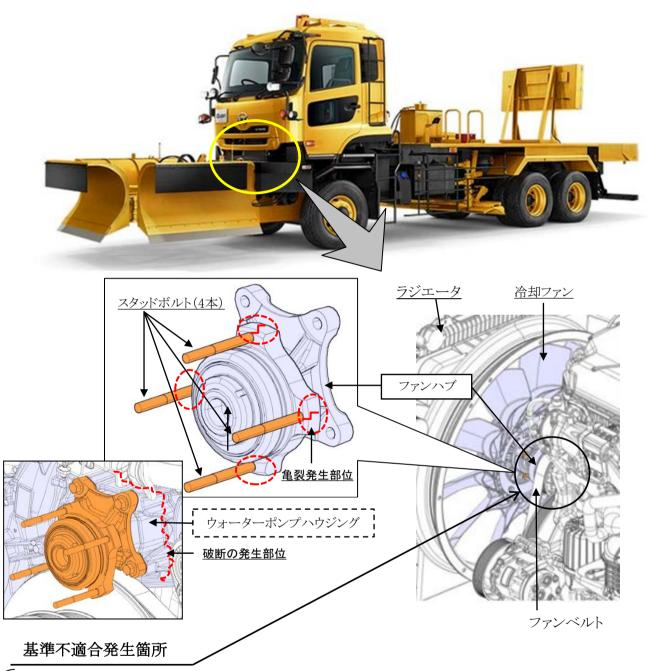
大型総輪駆動車の冷却装置において、ラジエータ冷却ファンと締結するファンハブに取付けたスタッドボルトの締付け方法が不適切なため、当該ハブのスタッドボルト挿入部に亀裂が発生し緩むものがある。そのため、冷却ファンが回転振れし当該ハブ固定部のウォーターポンプハウジングに負荷が掛かりウォーターポンプハウジングが破断すると、冷却ファンと一体でラジエータ側へ脱落して、最悪の場合、ラジエータコアが損傷し冷却水漏れにより走行不能、または、ウォーターポンプハウジングの一部破片が路上に落下するおそれがある。
