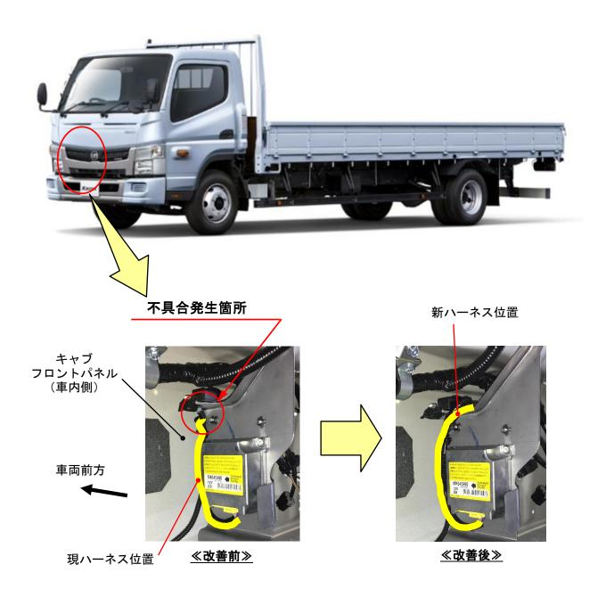
小型トラックにおいて、運転席用エアバッグECU用配線の配索が不適切なため、衝突時のフロントパネルの変形により、当該配線がフロントパネルと当該ECU取付金具の間に挟まって切断され、エアバッグが展開しないおそれがある。
