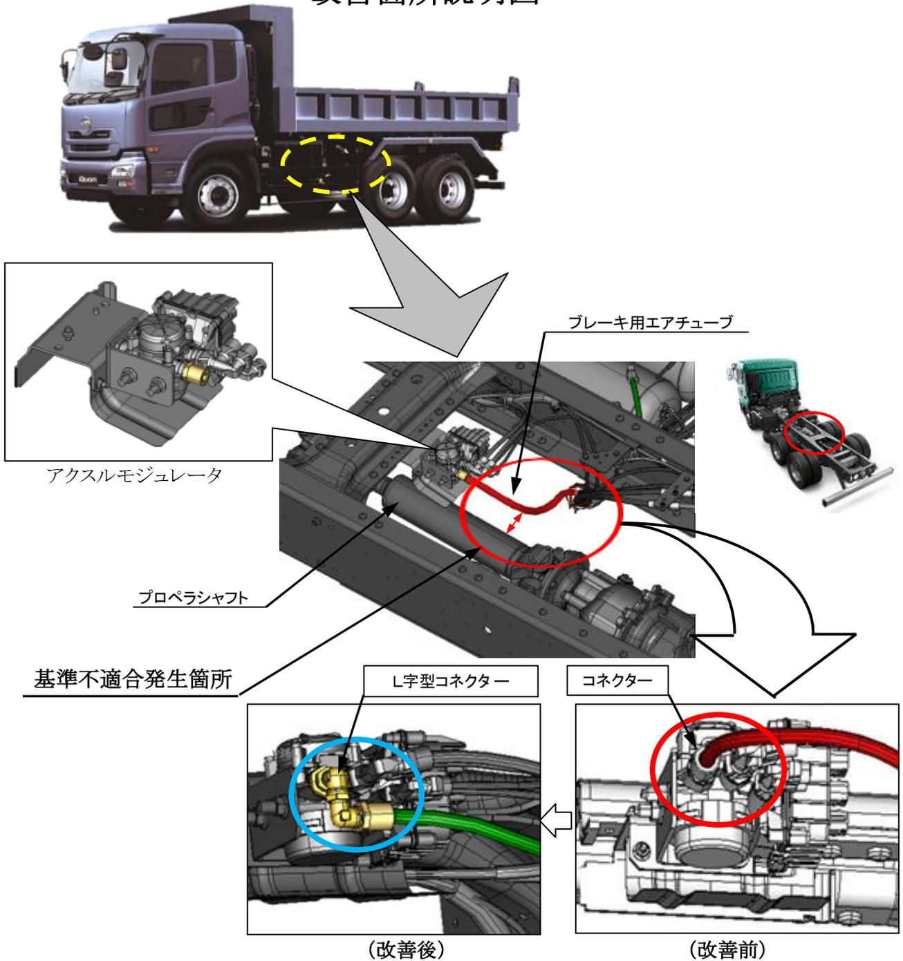
制動装置において、ブレーキ用エアチューブの配策が不適切なため、起伏の大きい悪路を走行した際に、当該チューブがプロペラシャフトと接触することがある。そのため、そのままの状態で使用を続けると、当該チューブが損傷してエア漏れによるブレーキ警告灯が点灯し、最悪の場合、制動力が低下するおそれがある。
