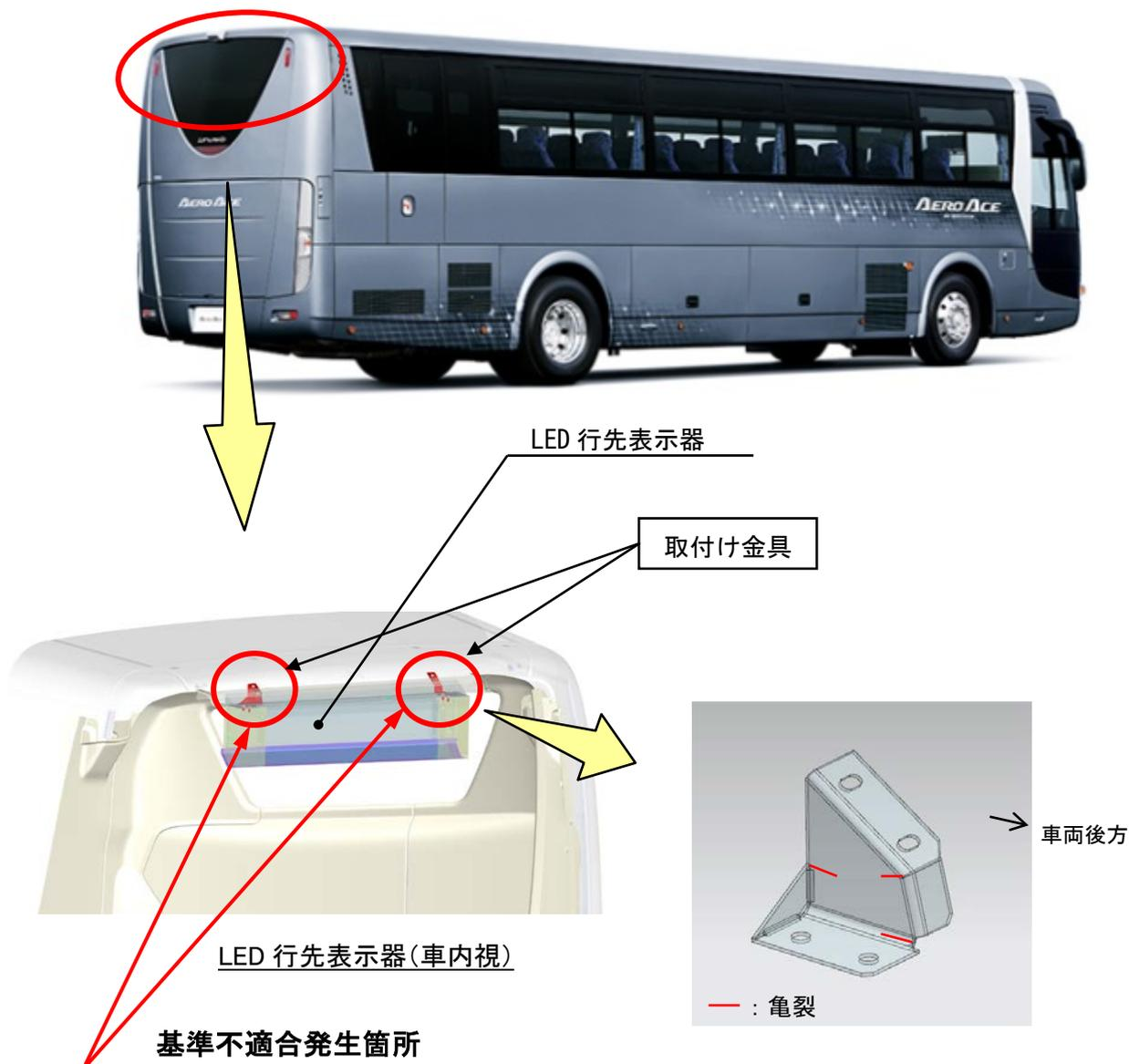
オプションの車両後側用 LED 行先表示器を装着した大型観光バスにおいて、行先表示器の取付け金具の強度が不足しているため、車両振動により当該金具に亀裂が発生するものがある。そのため、そのままの状態で使用を続けると、亀裂の進行により当該金具が破断し、行先表示器が脱落するおそれがある。
