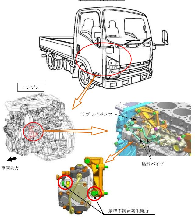
小型トラックの燃料噴射装置において、サプライポンプをエンジンに取付ける締付指示が 不適切なため、締結力が不足しているものがある。そのため、そのまま使用を続けると、サ プライポンプ取付けボルトの締結部が緩んで振動が増大し、最悪の場合、燃料パイプが亀裂 し、燃料が漏れるおそれがある。
