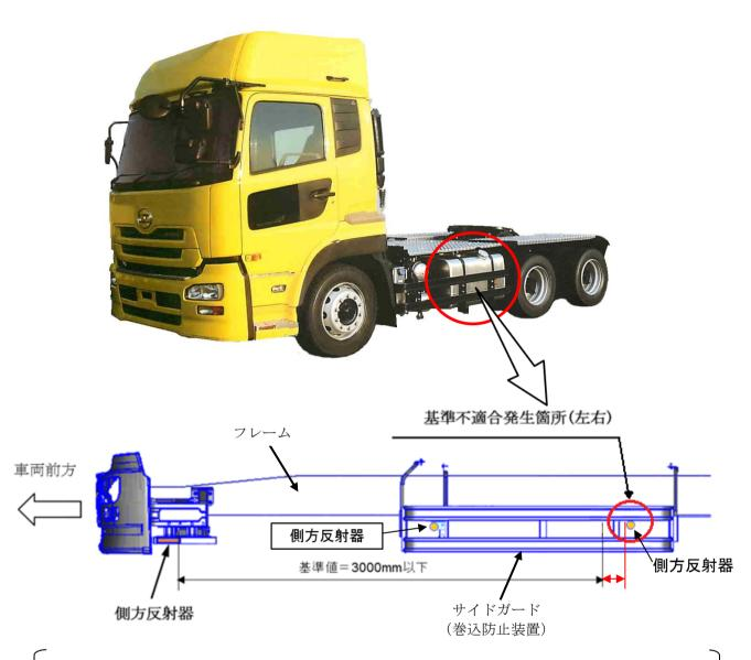
トラクタ(全長6m超え)に備える左右の側方反射器の取付け位置が不適切なため、 保安基準第35条の2(側方灯及び側方反射器)の規定寸法に適合しない。
