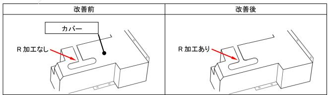
大型バスの運転者席において、座席ベルトの巻取り器を格納するカバーのスリット端部の加工が不適切なものがある。そのため、そのままの状態で使用を続けると、座席ベルトが当該スリット端部に引っ掛かり、損傷するおそれがある。
