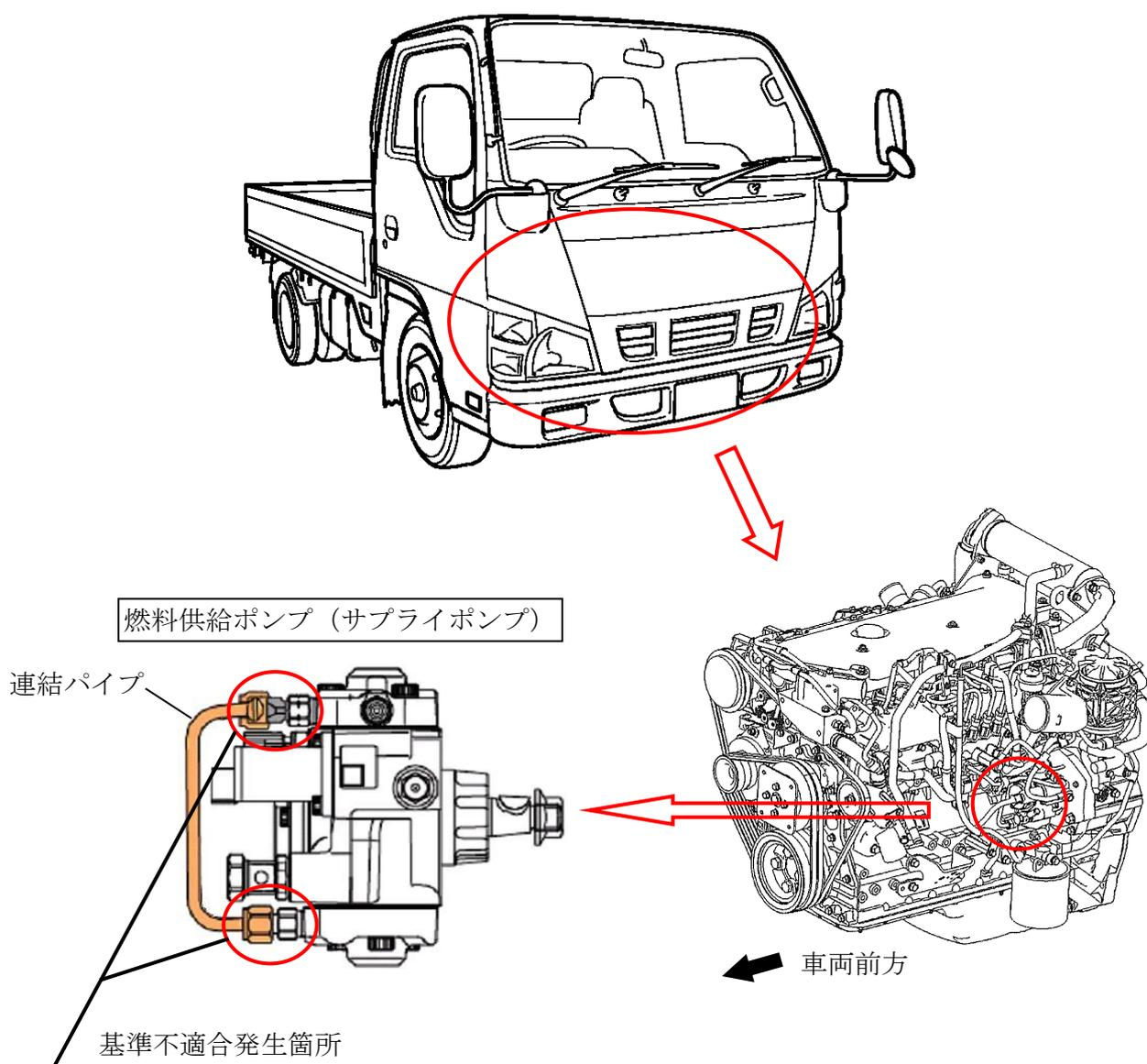
燃料噴射装置の燃料供給ポンプ (サプライポンプ) に接続するパイプのナット締結力が不足しているため、気密の確保が不十分なものがある。そのため、そのままの状態で使用を続けるとパイプ締結部から燃料が漏れるおそれがある。
