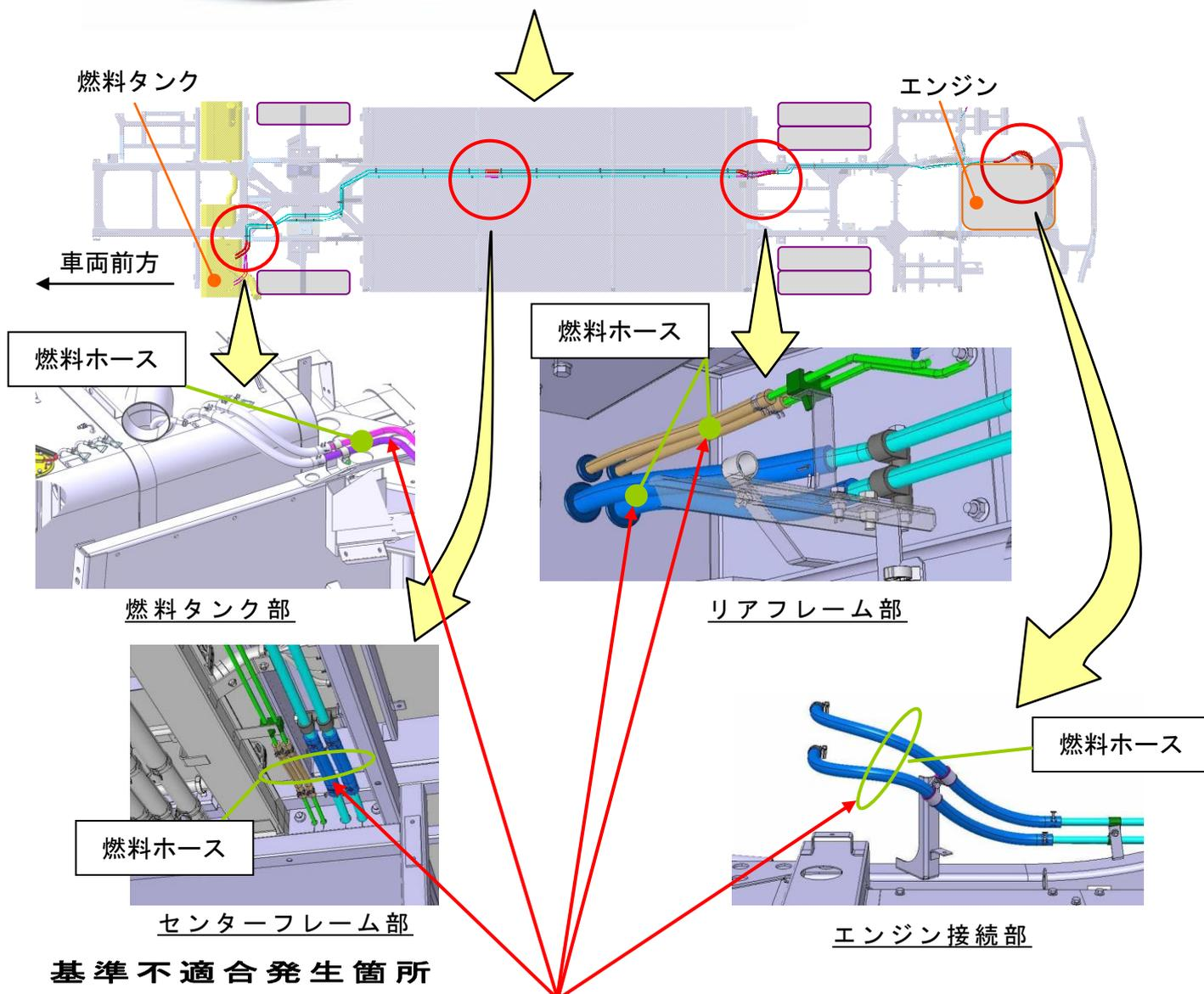
大型トラック・バスにおいて、燃料ホースから溶け出した亜鉛が軽油中の成分と反応して生成された化合物によって燃料噴射装置の内部バルブが固着する場合があります。そのため、エンジンの異音、白煙の発生、エンジン制御システム異常の警告灯点灯などが生じ、最悪の場合、エンジンの始動不良や吹け上がり等に至るおそれがある。
