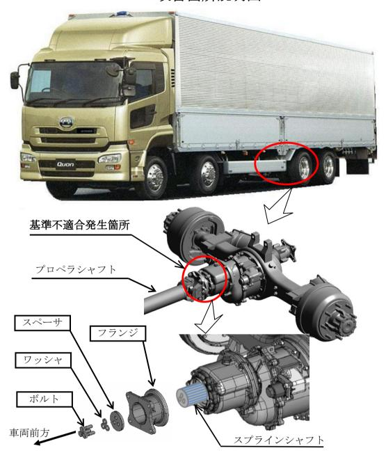
低床式後2軸駆動の大型トラックの後前軸側終減速機において、前側フランジのスプライン部の遊びが大きいため、当該フランジとスプラインシャフトを固定する締結用ボルトに過大な入力が生じることがある。そのため、そのままの状態で使用を続けると、当該ボルトが折損し、最悪の場合、当該フランジと接続されているプロペラシャフトが脱落し、走行不能となるおそれがある。
