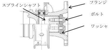
大型トラックのプロペラシャフトにおいて、スプラインシャフトの寸法が小さいため、それと結合するフランジとの間の遊びが大きいものがあり、当該フランジとスプラインシャフトを固定する締結用ボルトに過大な入力が生じることがある。そのため、そのままの状態で使用を続けると、当該ボルトが折損し、最悪の場合、プロペラシャフトが脱落し走行不能となるおそれがある。
