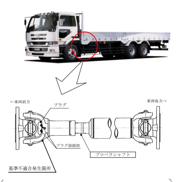
プロペラシャフトのプラグ溶接位置の指示が不適切なため、溶接部の強度が不足しているものがある。そのため、そのまま使用を続けると、プラグ溶接部に亀裂が生じ、最悪の場合、プロペラシャフトが破損し、走行不能となるおそれがある。
