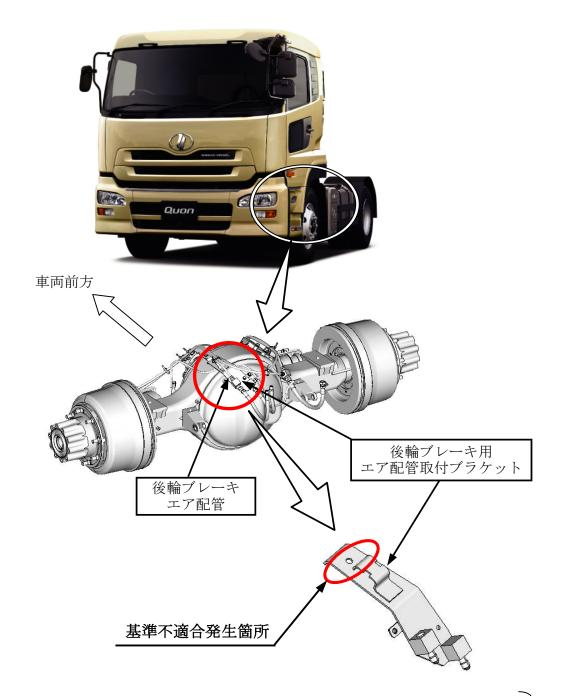
後輪ブレーキ用エア配管取付ブラケットの強度が不足しているため、走行時の路面 入力等によって当該取付ブラケットに亀裂が発生するものがある。そのため、そのま ま使用を続けると、当該取付ブラケットが折損し、最悪の場合、ブレーキエア配管が 損傷してエアが漏れ制動力が低下するおそれがある。
