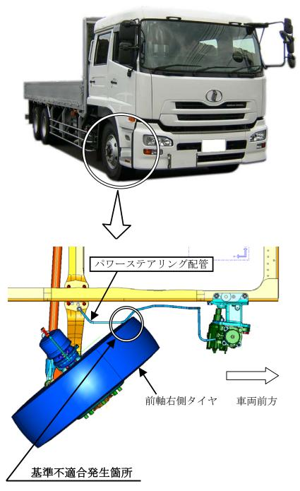
大型ダブルキャブ車において、パワーステアリング配管の形状が不適切なため、ステアリングを最大限度まで切った状態で段差等を通過した場合、タイヤが当該配管と接触するものがある。そのため、そのままの状態で使用を続けると、接触部分が損傷し、最悪の場合、オイルが漏れ、ステアリングの操舵力が過大になるおそれがある。
