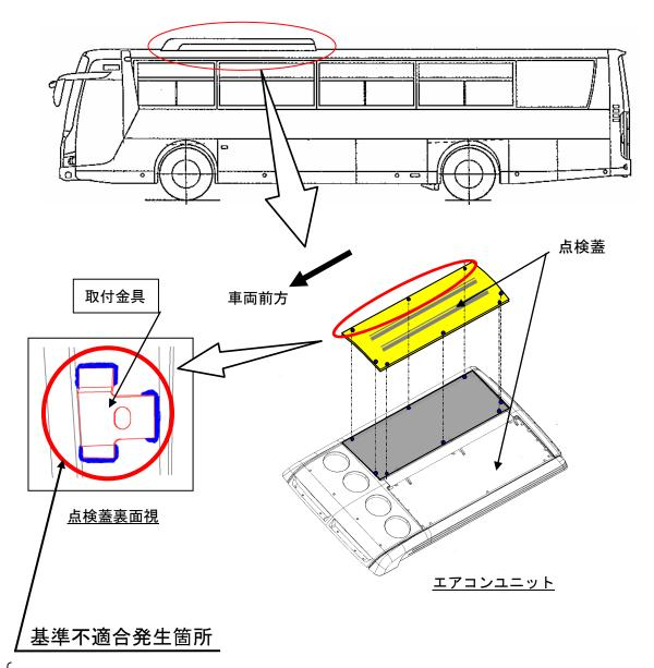
ルーフに装着しているエアコンユニットの点検蓋を固定するための取付金具の接着部が剥がれるものがある。そのため、そのままの状態で使用を続けると、当該点検蓋が脱落するおそれがある。
