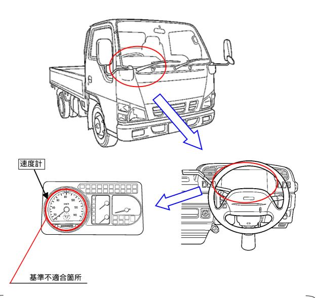
メーカーオプション仕様の速度計において、仕様の設定が不適切なため、速度計の 指示範囲が車両の性能上の最高速度を表示できない車両がある。
