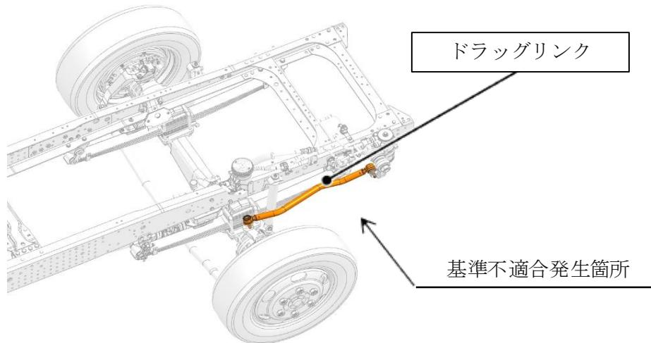
ドラッグリンクにおいて、製造工程での作業指示が不適切なため、フロント側を示すラベルをリヤ側に貼付けたものがある。そのため、ドラッグリンクを車両へ前後逆に組付けたことにより、タイヤとの隙間が小さくなり、タイヤチェーン装着時にドラッグリンクとタイヤチェーンが接触するおそれがある。
