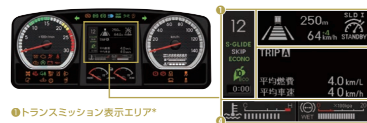
オートクルーズ車速設定 車間クルーズ車速設定 可変スピードリミッター車速設定 (I/II)
