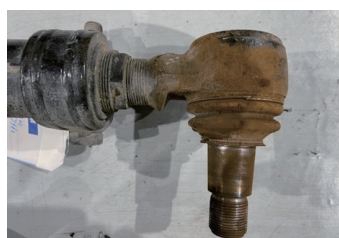
ボールジョイント全体に錆汁付着の例
