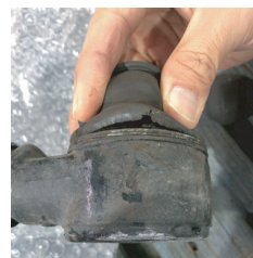
摘んでブーツがひび割れた例
