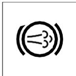
Lampu indikator ini menyala pada saat switch exhaust brake di hidupkan.
