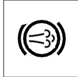
Untuk menggunakan exhaust brake selama pengendaraan, tarik tuas ke belakang. Lampu indikator exhaust brake akan menyala. Untuk membebaskan exhaust brake, tekan pedal akselerator atau pedal kopling (jika kendaraan Anda adalah kendaraan transmisi manual). Membebaskan pedal rem mengaktifkan kembali exhaust brake.
