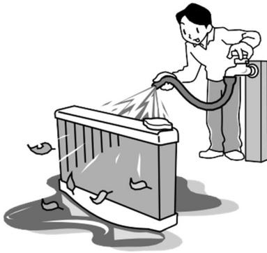
Jika benda asing (serangga, lumpur, dll.) menempel dalam saluran udara radiator, kinerja sistem pendingin akan memburuk. Periksa saluran udara apakah tersumbat, dan bersihkan berbagai benda asing menggunakan air yang bertekanan rendah.
