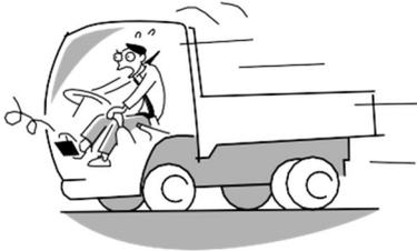
Jika rem tiba-tiba menjadi tidak efektif, mengurangi kecepatan dengan cepat memindahkan ke lebih rendah dari ketiga untuk kedua ke gigi ke1 menggunakan tuas perpindahan gigi. Tarik tuas rem parkir secara bertahap sambil memegang dengan roda kemudi dengan kuat. Hentikan kendaraan di tepi jalan
