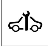
Lampu indikator SVS akan menyala pada saat kunci kontak berada di posisi "ON" dan mesin tidak dihidupkan, untuk memberi tahu Anda bahwa bola lampu bekerja.
