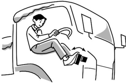
Ketika Anda menghidupkan mesin, periksa apakah pedal akselerator bekerja dengan baik.
