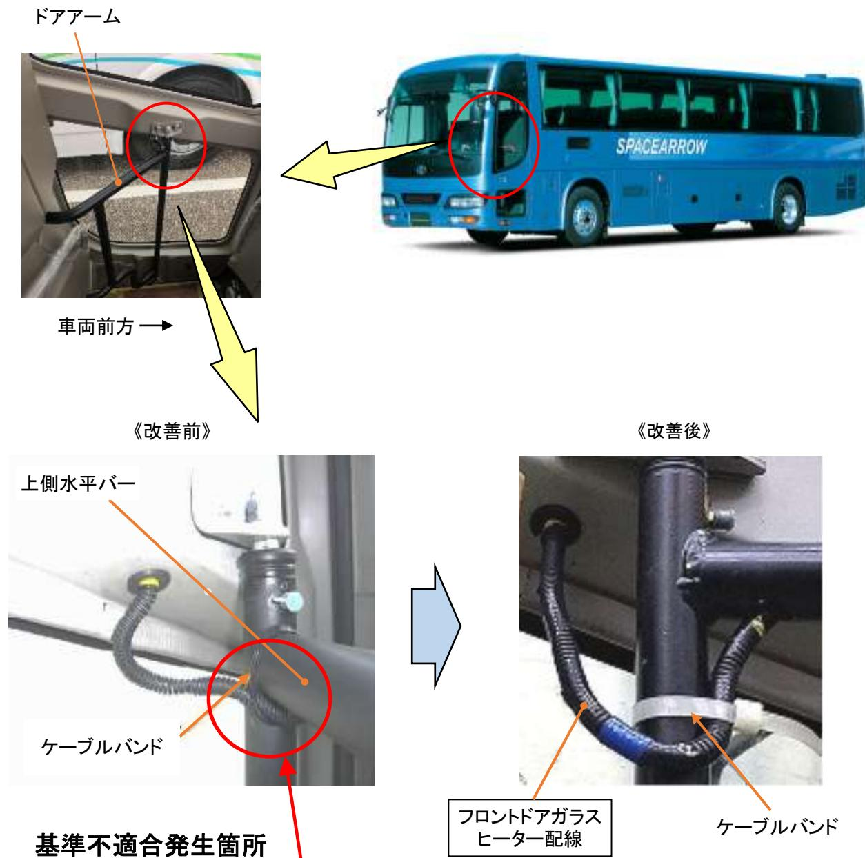
大型バスにおいて、オプション設定されているフロントドアガラスヒーターの配線の固定方法が不適切なため、ドア開閉時にアーム部（上側水平バー）の配線に局部的な曲げが生じるものがある。そのため、そのままの状態で使用を続けると、ドア開閉に伴って当該配線が繰り返し曲げられることで配線が断線し、発煙が生じるおそれがある。
