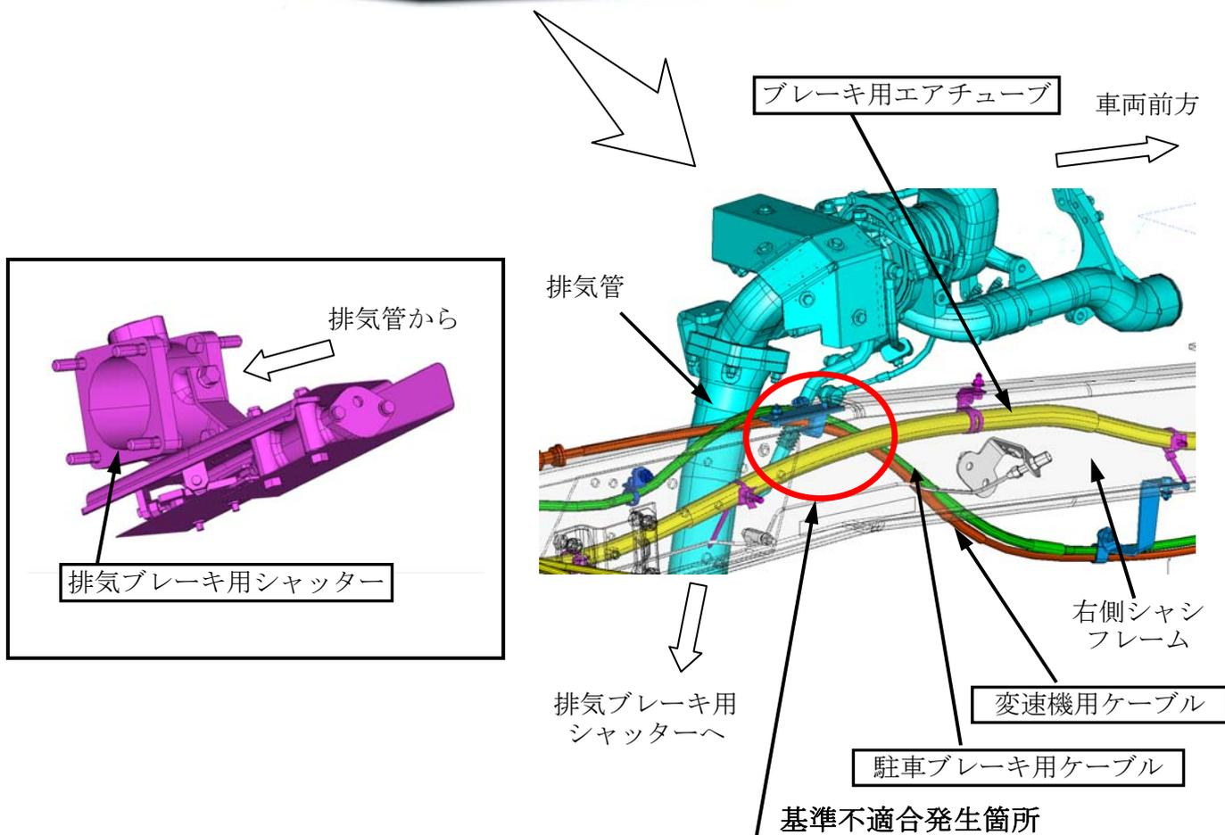
再生制御式DPFを搭載した車両において、排気管付近に配索されたブレーキ用エアチューブ、駐車ブレーキ用ケーブル及び変速機用ケーブルが、高温になる場合がある。そのため、そのままの状態で使用を続けると、エアチューブやケーブルが溶損し、制動力の低下、駐車ブレーキの作動不良及び変速機の操作性不良となることがある。
