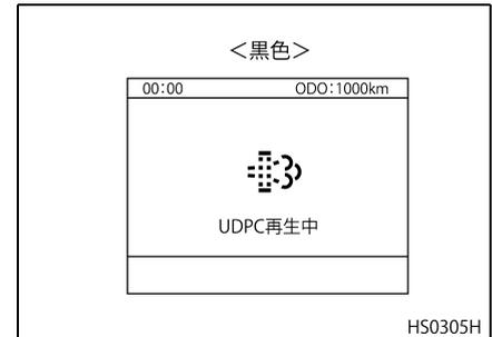
5. 排出ガス浄化装置パイロット ランプおよび排出ガス浄化装置再生中ウォーニングが消灯し、マルチディスプレイに“UDPCの手動再生を完了しました”が表示されます。手動クリーニングが終了し、しばらくするとアイドル回転数がもとに戻ります。
