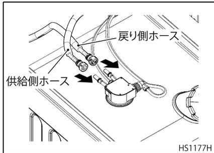
26. フィルター交換後、燃料システム内のエア抜き作業を行います。詳細は、“燃料系統のエア抜き” (13-25 ページ) の項を参照してください。
