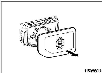
4. 電池を押さえている爪を押しながら電池を持ち上げて取り外し、新しい電池 (CR2032) と交換する。
