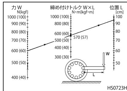
● ホイール ナット レンチに力をかけて締め付けるときは、前図によって力を加える位置を決めてください。
