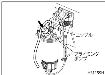
7. ニップルを締めます。パイプを取り外し、さらにニップルをトルク締めします。
