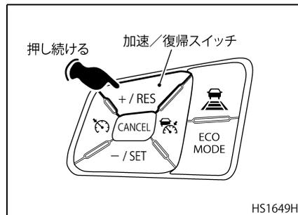
なお、早く加速したいときは、アクセルペダルを踏み込んで加速し、希望の車速になったとき、減速/セットスイッチを押してください。
