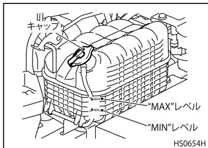
5. エンジンを始動して冷却水面が安定するまでエア抜き運転を行ってください。なお、冷却水量が少なくなった場合は冷却水を補給してください。
