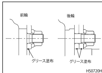
2. ハブ ボルトのねじ部を傷つけないように注意し、タイヤレバーなどを使ってディスクホイールをハブのはめ合い部のガイドにそって、ハブの奥まではめ込みます。ダブルタイヤの場合、内側タイヤと外側タイヤのエアバルブが対角線位置となるようにして取り付けてください。
