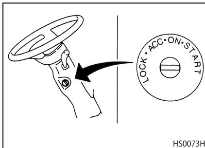
**LOCK (OFF)**：エンジンなどへの電源供給を停止する位置です。またエンジンキーの抜き差しおよびステアリングホイールのロック（施錠）はこの位置で行います。エンジンキーを抜いた後ステアリングホイールを回すと自動的にステアリングホイールは定位置でロックされ、盗難防止に役立ちます。
