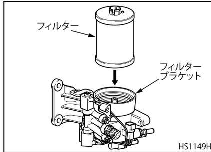
12. フィルター レンチを使用してフィルター カバーを取り付けます。
