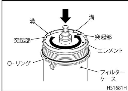
10. 41mmの六角ソケットを使用し、マークがエンジン本体側のマークの間になるようにセカンダリー フューエル フィルターを取り付けます。
