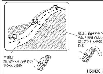
●「踏力変化点」を越えて踏み込んでシフトダウンした後、すぐに「踏力変化点」の手前まで戻すと、シフトアップする場合があります。ギヤを保持したい場合はアクセルを「踏力変化点」を越えて踏み続けてください。
