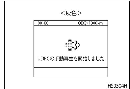
4. クリーニングが開始されると、マルチディスプレイに“UDPC 再生中”が表示され、アイドリング回転数が上昇します。
