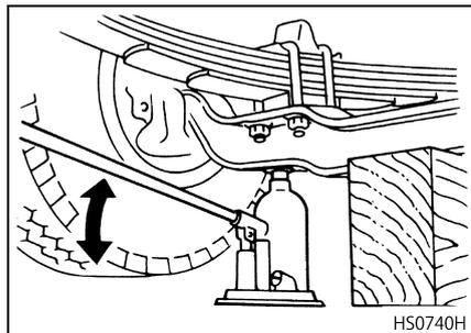
6. タイヤ交換後は、使用した角材を取り除いた後、ジャッキをゆっくり降ろします。
