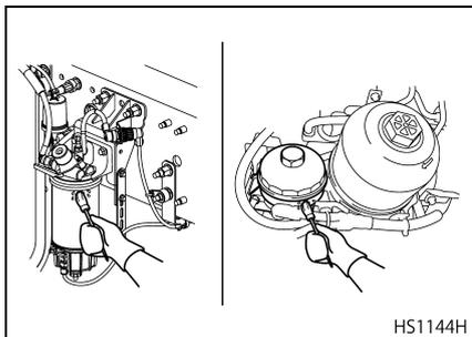
4. フィルター レンチを使用してフィルター カバーを取り外します。
