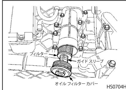
3. 新品のフィルター を取り付け、オイル フィルター カバー を取り付けます。
