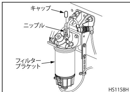
6. プライマリーフューエルフィルターブラケットに取り付けられているプライミングポンプを、気泡がなく燃料が流れ出るまでポンピングします。
