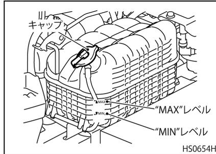
6. エンジンを始動し、高めのエンジン回転数で約 30 分間運転を行います。なお、エンジンを始動して 5 分間は冷却水量に注意し、少なくなった場合は水道水を補給してください。
