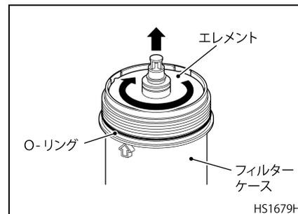
7. フィルターケース内、フィルターケースのO-リング取り付け部およびエンジン側フィルター取り付けねじ部を清掃します。
