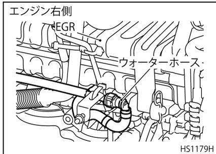
5. ドレーンコックを閉じ、トランスミッションオイルクーラー (ESCOT仕様車のみ) およびエンジンブロックのウォーターホースを接続し、キャブを降ろして、水道水をウォータータンクから注入します。
