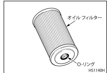
9. オイルフィルターカバーに新品のO-リングを取り付け、オイルを薄く塗布します。
