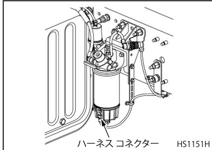
25. 燃料タンクの供給側および戻り側のホースを取り付けます。
