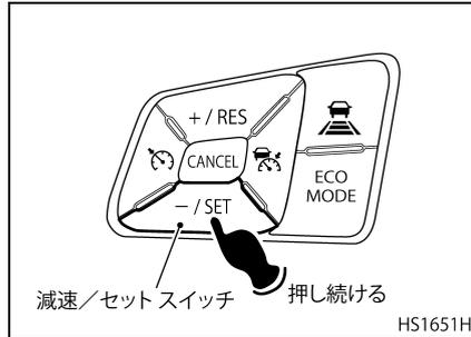
なお、早く減速したいときは、ブレーキペダルを踏み、希望の車速になったとき、減速/セットスイッチを押してください。
