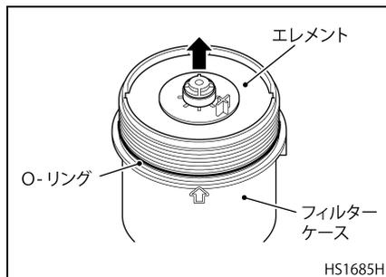
17. フィルターケース内、フィルターケースのO-リング取り付け部およびエンジン側フィルター取り付けねじ部を清掃します。
