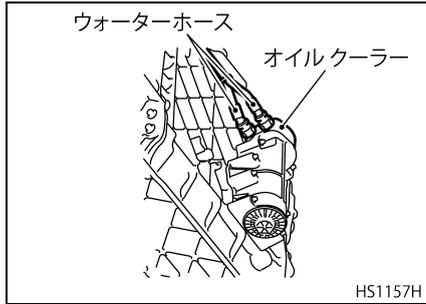
4. キャブをティルトさせ、エンジンブロックにドレーンホースを取り付け、冷却水を排出してください。
