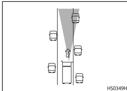
(例3) 制御対象としていた車両が店舗などに進入した際、その車両の後ろを追い越すように通り抜ける場合
