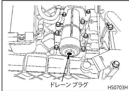
2. オイル フィルター カバー とガイド スリーブ を取り外し、フィルター を交換します。
