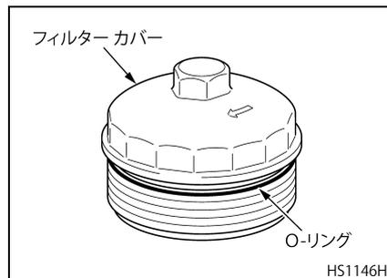
7. フィルター カバーの O-リングのシール面やフィルター ブラケット周辺の汚れを完全に落とします。
