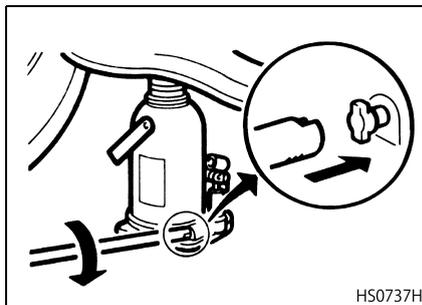
4. ジャッキ ハンドルをセットし、上下に動かしてジャッキアップします。
