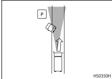
(例4) 分岐路に車線変更しながら進入するとき、自車正面の分離帯のガードレール等を制御対象として検出した場合
