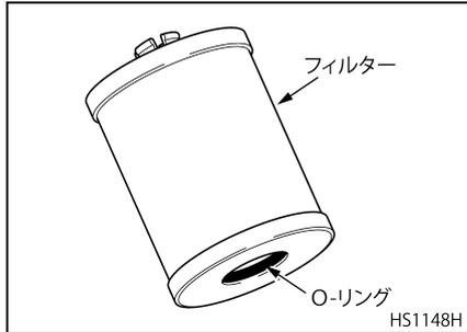
10. フィルター カバーに O-リングを取り付け、O-リングに燃料を塗布します。
