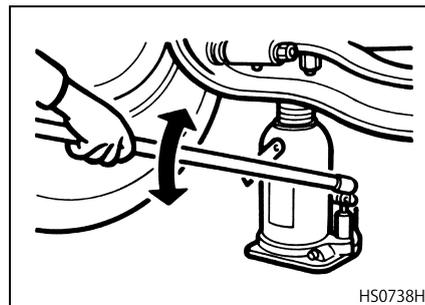
5. 下げるときは、ジャッキ ハンドルを使ってリリースバルブを左に少しずつ回して開け、ジャッキをゆっくり降ろします。
