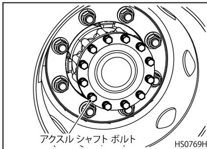
もし、ボルトが回転した場合は異常ですので、一度アクスルシャフトを取り外してハブとアクスルシャフトとの接触面にシーラ剤（ロックタイト 518）を塗布し直し、ボルトを新品に交換の上、規定の方法と値で締め付けてください。
