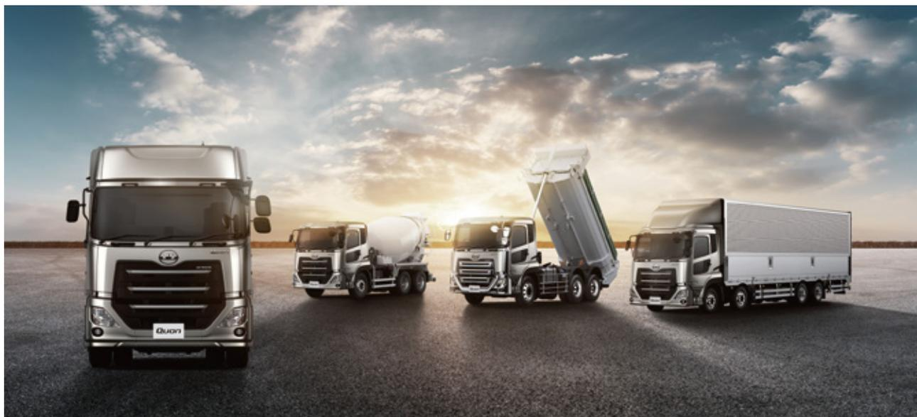
UDトラックスは、2019年1月、大型トラック「クオン」のラインアップに、8リッターエンジン（GH8）搭載のカーゴ、ダンプ、ミキサー車を、また、2020年12月にはタンクローリー車を追加しました。従来の11リッターに比べ軽量でコンパクトなエンジンを採用したことで、積載量の大幅な増加を可能にするとともに、燃料消費と排出ガスの削減を実現。また、平成28年排出ガス規制適合、全車重量車燃費基準+5%を達成しています。
