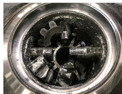
デファレンシャルギヤ破損例
